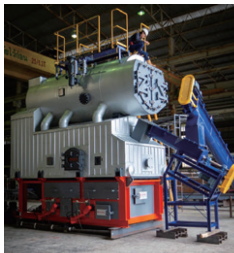
タイで導入されている GETABEC 製バイオマスボイラー (3t/h)。
